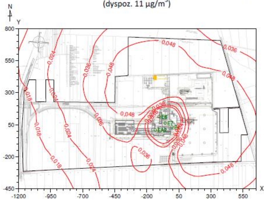
Izolinie stężeń średnich pyłu zawieszonego PM 2,5 w fazie rozruchu \mu\text{g}/\text{m}^3 (dyspoz. 11 \mu\text{g}/\text{m}^3 )
